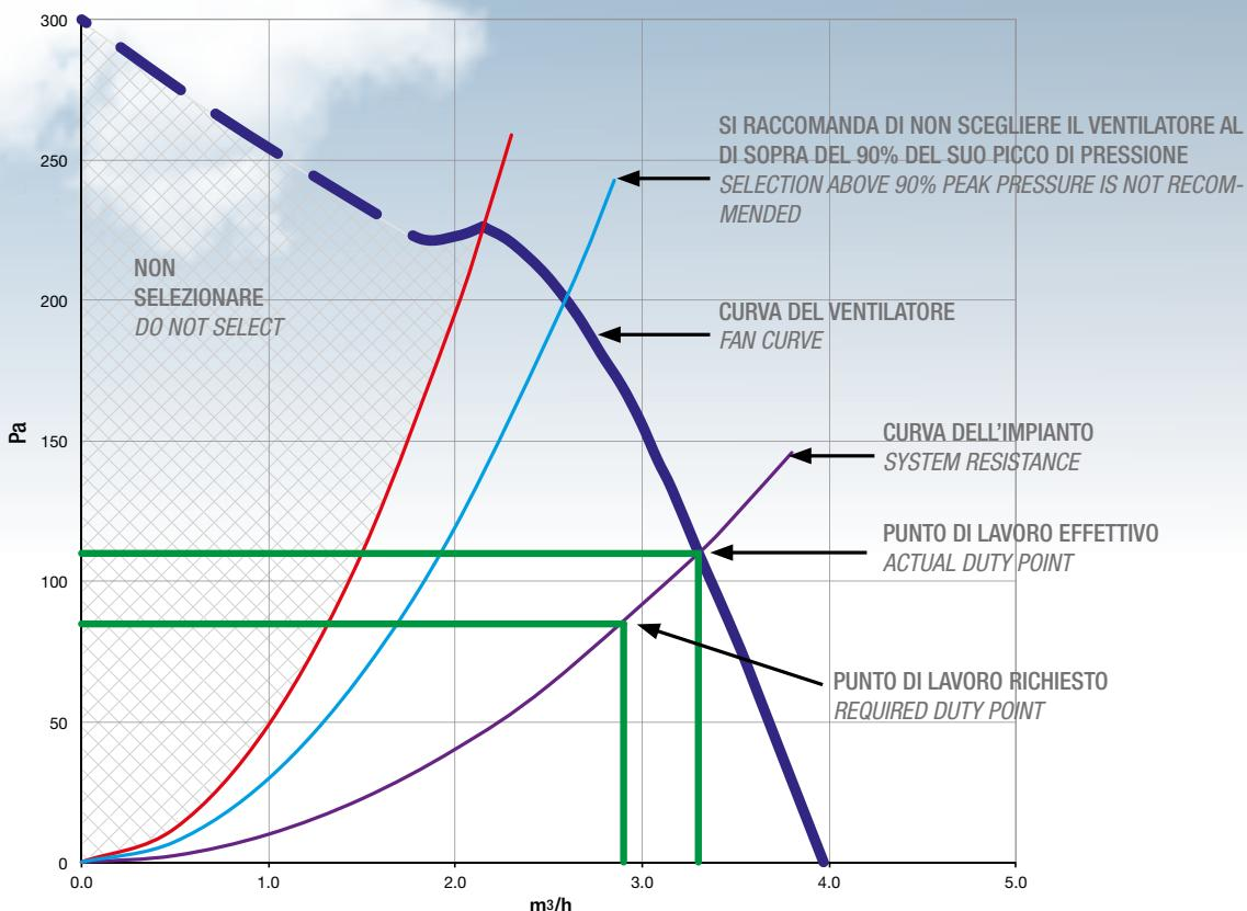
Il punto di lavoro effettivo del ventilatore è dato dall'intersezione della curva dell'impianto con quella del ventilatore
