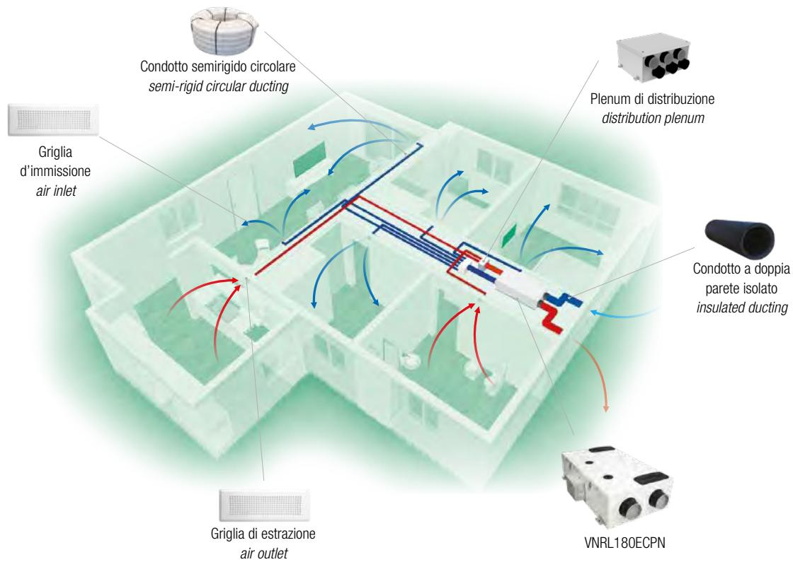
Sistema di ventilazione realizzato utilizzando un'unità ventilante centralizzata a doppio flusso con recupero di calore VNRL180ECP con sistema di distribuzione dell'aria: rappresenta la soluzione ideale in caso di edifici nuovi. *Ventilation system with one heat recovery VNRL180ECP with dedicated air distribution system: this system represents the ideal solution in case of new building.*
