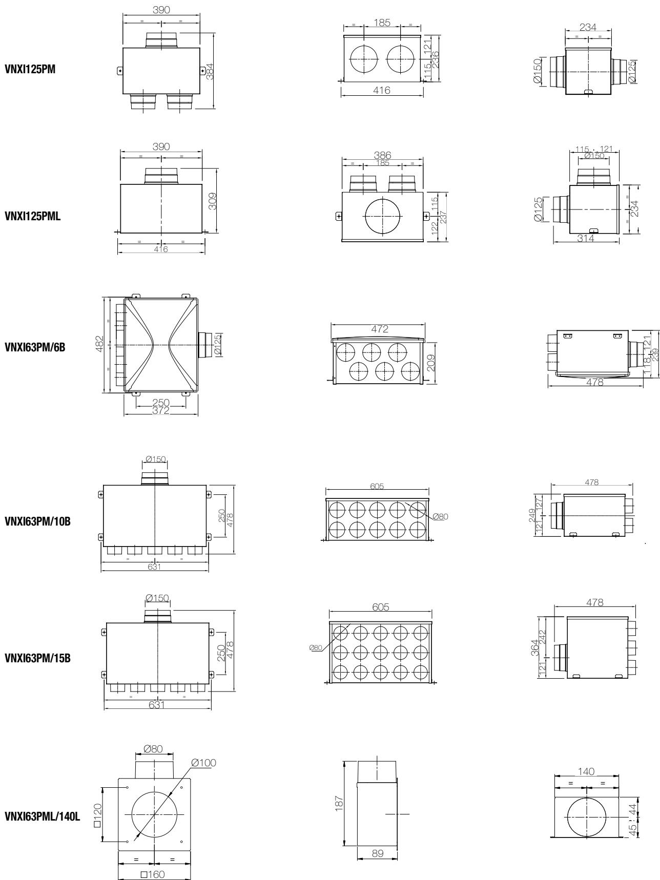
**Sistema di distribuzione aria per VMC canalizzata**
