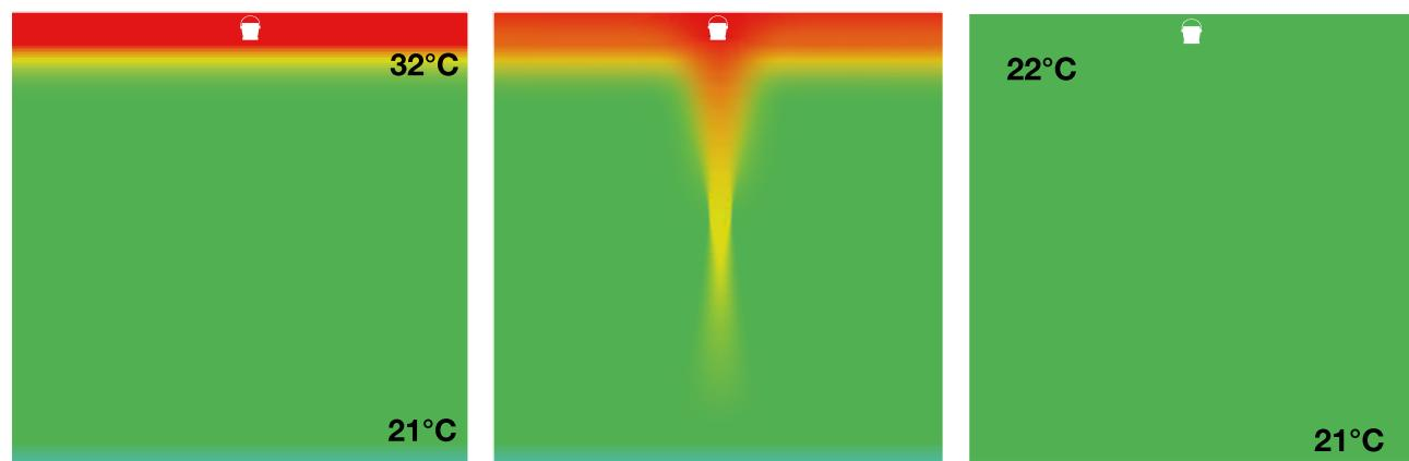
La figura sopra riportata è presa da un modello CFD (Computational Fluid Dynamics) di un ambiente di dimensioni 12,2m x 12,2m con un soffitto alto 7,6m e con la fonte di calore installata a soffitto e provvista di termostato fissato a 1,5m dal pavimento, settato a 21°C.
