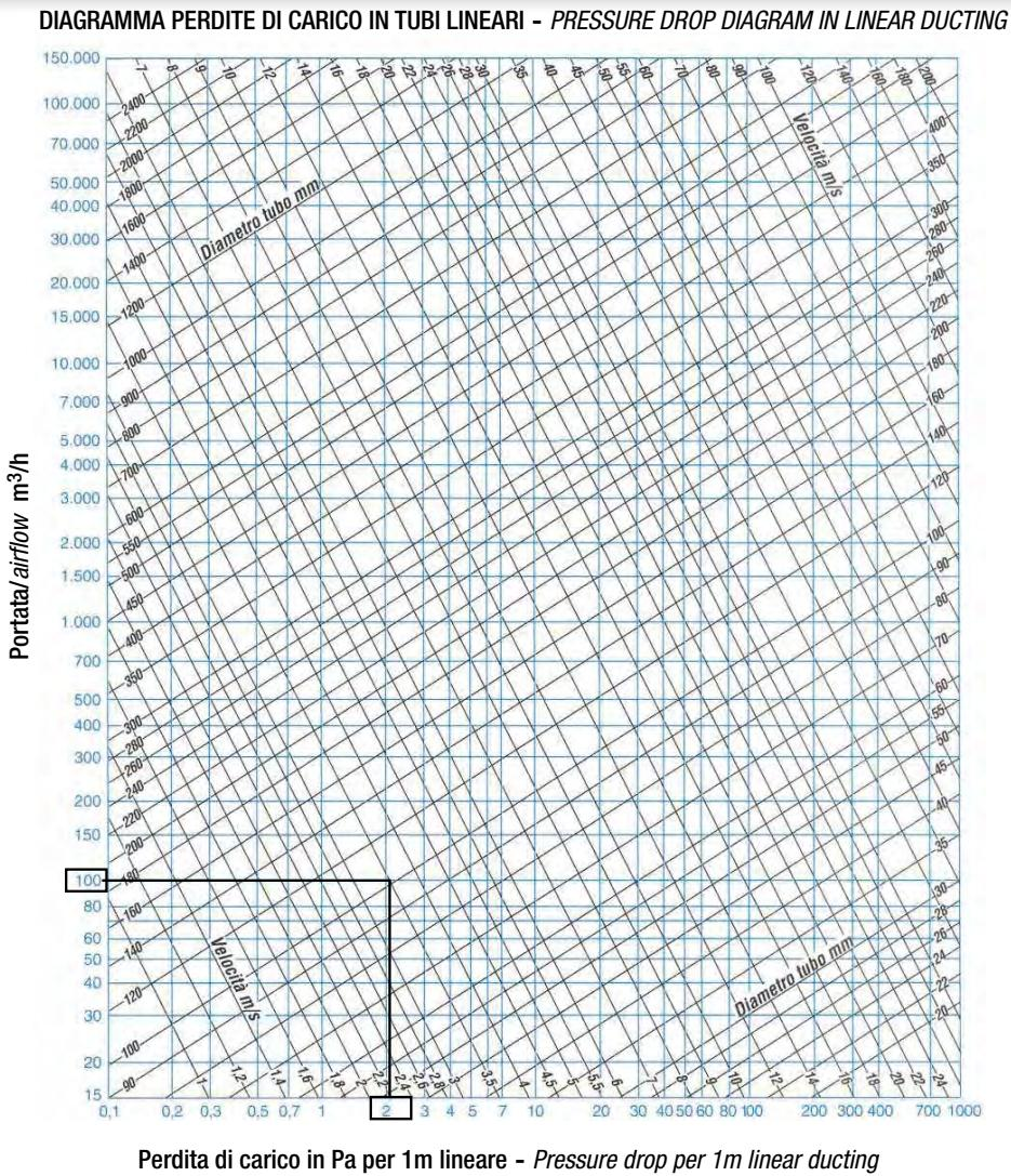
In caso di impianti di ventilazione canalizzati, per scegliere correttamente il ventilatore deve essere calcolata la perdita di pressione distribuita, generata dagli attriti delle tubazioni, e quella concentrata, legata a curve, filtri, serrande, ecc.
