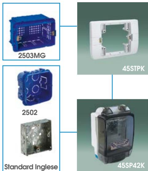
L'installazione da incasso si ottiene grazie alla piastra adattatrice cod. 45STPK che consente di adattare il coperchio AVE SEAL 2 moduli su scatole rettangolari 3 moduli standard con interasse 83,5 mm.
