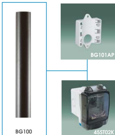
L'installazione lungo il palo è ottenuta grazie all'accessorio cod. BG101AP il quale consente di applicare il contenitore AVE SEAL 2 moduli direttamente su pali con diametro 35/40 mm fino a 55/60 mm
